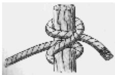
**Nœud de cabestan** : C'est un nœud d'amarrage. Il n'a pas besoin d'être serré. Sur un appui libre, on peut le faire très simplement en formant deux boucles et en les superposant.
